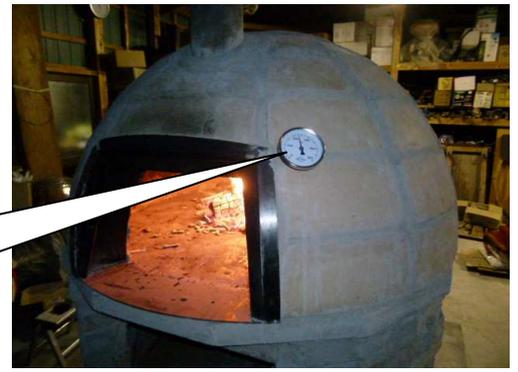
ネットで購入したドイツ製の温度計。500度迄計測可能。
