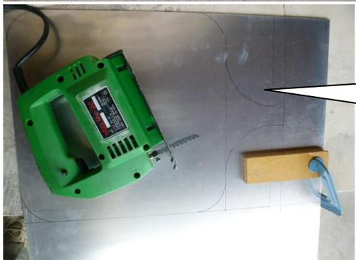
「プレート」部はt=1.5mmのアルミ板をジグソーで切断
