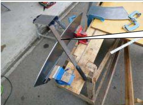
入り口の扇型部を切断。ジグソーの切断スピードは0.5mm/secぐらいでゆっくりと押し付けながら切断します。
