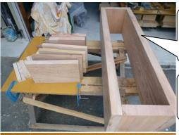
板材は全て手持ち材料。板材を切り出し鉋をかけテレビ台となる木枠を組上げたところ。台の板厚は40mm水平直角精度を出す為一日がかりで鉋がけしました。
