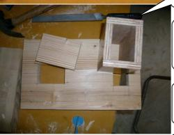
テレビ台にバッフル板を取り付け。 ストック品のスピーカは16cmウーハー、 Fセロが不明です。発振器で簡易 計測、80Hz前後でした。
