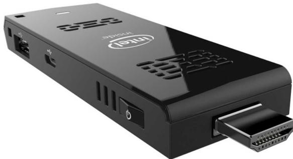
CPUなどのメーカーであるインテル製で、正面には「intel inside」と白文字で大書され、本体は、実測すると、長さ103×幅38×厚さ13(mm)(突起部分除く)という小さいもので、手のひらの中に収まります。一端にHDMIプラグが突き出た形状は、少し大きめのUSBメモリ、という感じです。
