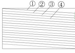
ばかりを走査して2回(2フィールド、約3 0分の1秒間)で全ての走査線の走査を終え るものです。これを飛び越し走査(インター レース)といい、英語の頭文字を取って 「i」で示します。2フィールドで完全な映 像1コマが表示でき、これを1フレームと言 います。
