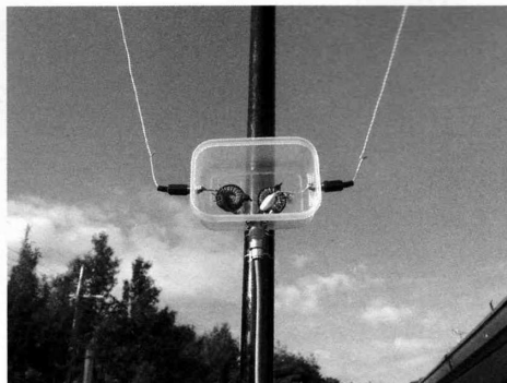
写真2 デルタループの給電部
